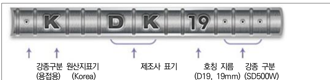
<그림 1> 철근 제품 표면의 원산지 표기 예(SD500W D19 철근의 경우)
